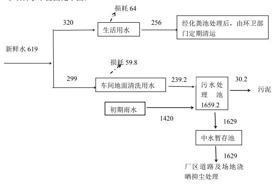
图 1 项目水平衡图 (单位: m³/a)
